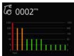
Gráfico da concentração de NO2 detetada no ambiente.
